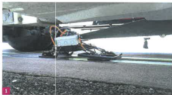
1. Un patin disposé sur le plancher du véhicule permet la mise en contact électrique avec le rail. 2. Alstom teste cette nouvelle technologie sur une piste d'essai de 308 m à Göteborg, en Suède.
